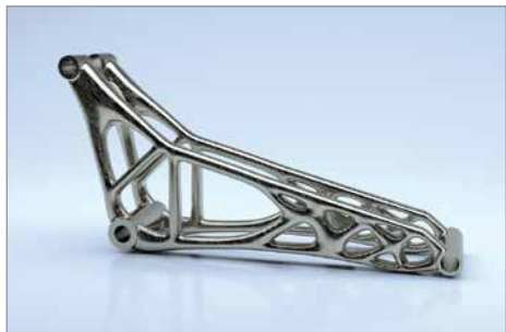
3Dプリンターで作成された バイクのロッカーアームの最適なコンセプト
