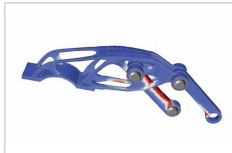
最適化されたロボットグリッパーアームの解析
